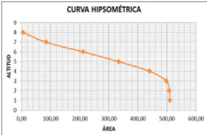
Figura 2. Curvas hipsométricas de la Cuenca del A° El Palmar (izq.) vs. Madurez de la cuenca en función de las curvas hipsométricas (derch.) según Strahler, (1976).
